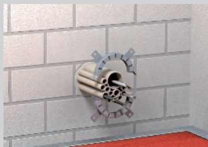
Unirea jumătăților dispozitivului și fixare pe perete.
