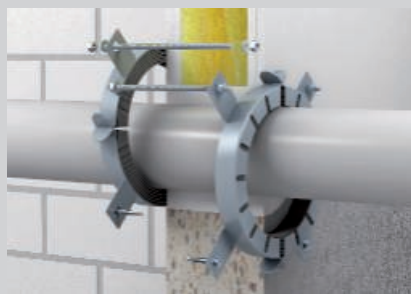
Disponere excentrică cu dispozitive de etanșare a țevilor în max. 3 trepte.
