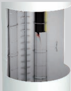
Secțiune verticală bandajată în turul unei instalații eoliene.
