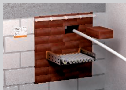
Instalarea ulterioară simplă prin scoaterea blocurilor individuale.
