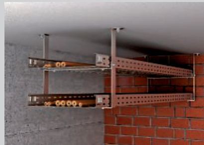
Montaj pe tavan în două straturi cu bridă de suspendare și bridă intermediară.
